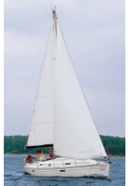
Einfache Handhabung: Topptakelung, Rollvorsegel und Lattengroß – da ist keine Hektik bei Manövern angesagt.
